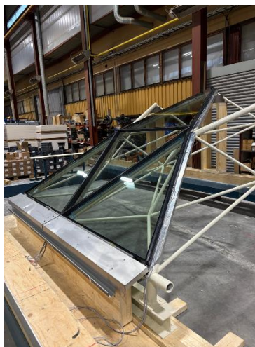
Kuva 10-11. Halkopihan lasikatteen mallin rakenteiden tarkastelua ja valmis malli.
